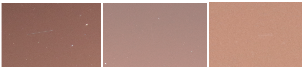
Figura 13. Tipuri de ținte de observat: stânga - țintă vizibilă, cu mișcare aparentă mare, mijloc: țintă cu mișcare aparentă mare, dar contrast scăzut, dreapta: contrast mediu dar mișcare aparentă redusă.
