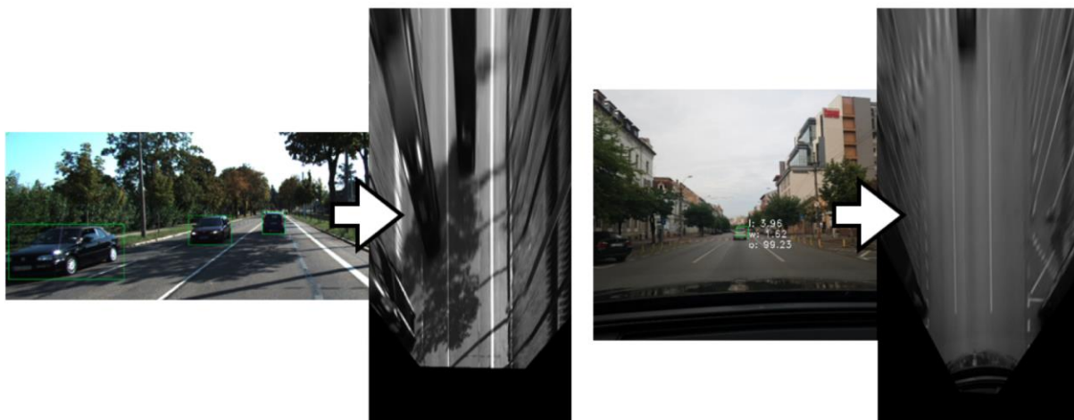
Figura 10. Generarea imaginii “bird’s eye view” folosind parametri calculați din calibrare.
