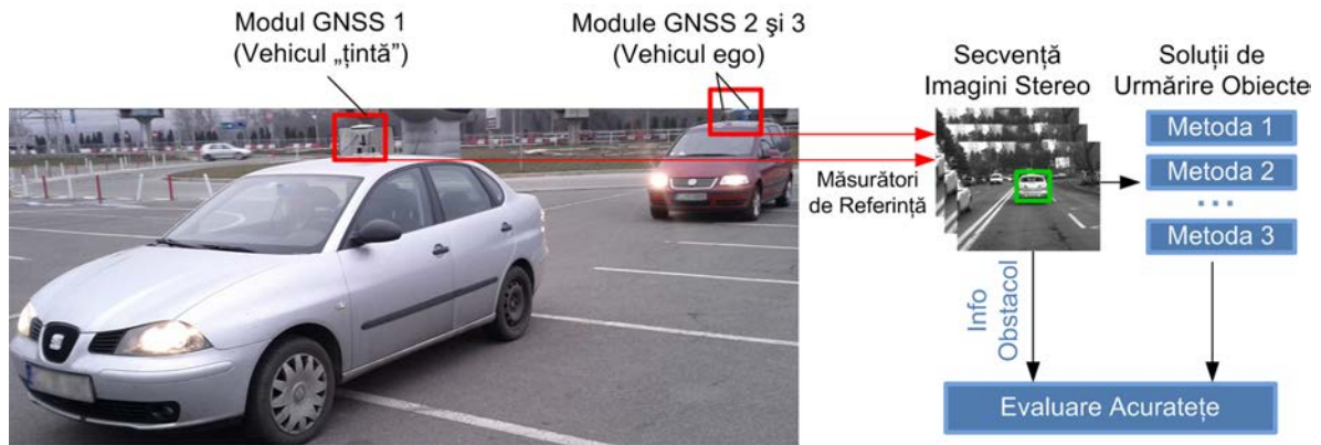
Fig. 7. Achiziția măsurătorilor de referință furnizate de sisteme GNSS de înaltă acuratețe montate pe Vehiculul propriu (vehiculul pe care se află platforma stereo) și pe un vehicul „țintă” (vehicul de test).
