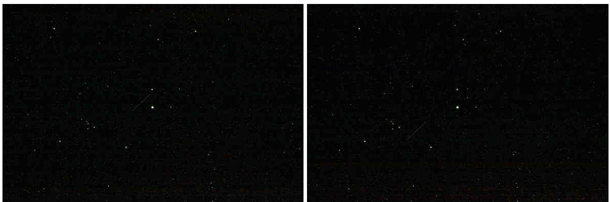
Fig. 2.8. Observații obținute în data de 2014.09.19, 00:01:48 UTC (imaginea din stânga), 00:01:56 UTC (imaginea din dreapta), timp de expunere =5 s, pentru satelitul operațional Galileo GSAT 0103-PRN19 (#38857U), steaua din zona centrală a imaginii este SAO 53834.
