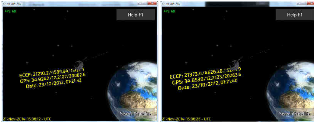
Fig. 4.4. Vizualizarea unui satelit in doua cadre consecutive dupa coordonatele ECEF calculate cu aplicatia de detectie
