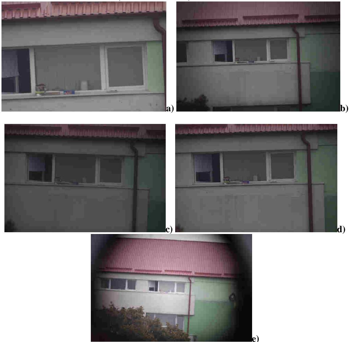
Figura 3. Exemple de imagini de test: a) - sistem optic original (telescop F=2400\text{mm} ); b), c), d) - sisteme optice obținute cu telescopul original ( F=2400\text{mm} ) și cele 3 reductoare de focală cu raport focal nominal f/6.3 testate; e) - sistem optic obținut cu telescopul original ( F=2400\text{mm} ) și reductorul de focală cu raport focal nominal f/3.3 testat (se observă vignetaiea câmpului și distorsiuni radiale ale câmpului).
